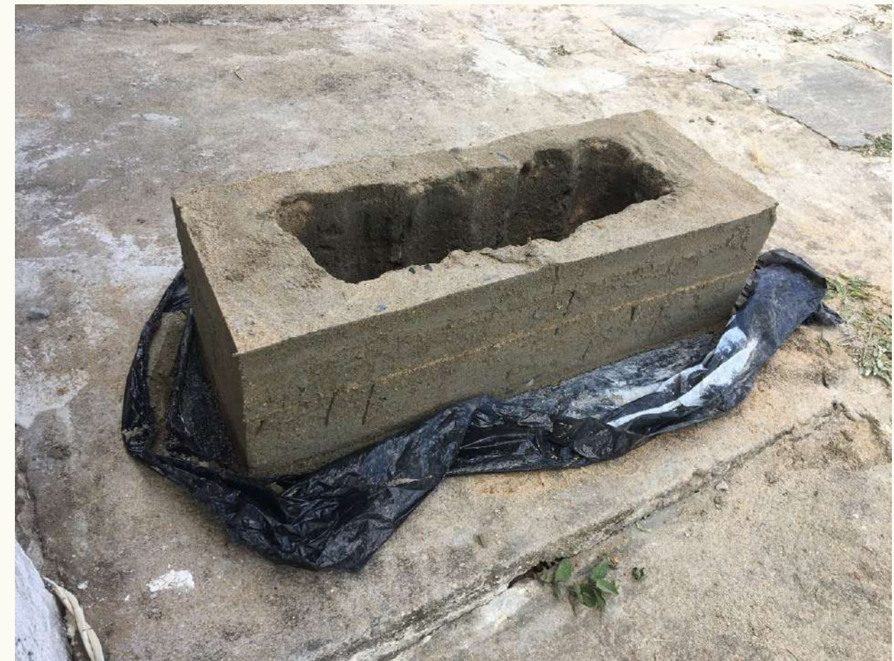
secagem do concreto
